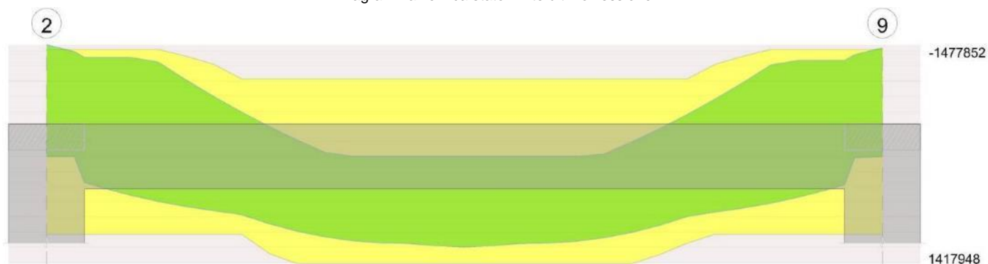
Diagramma verifica stato limite ultimo taglio
